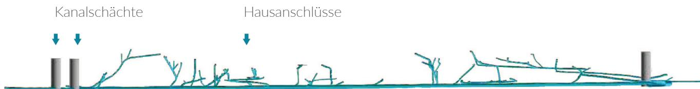
Wenn das Erdreich durchsichtig wäre... könnte man die Hausanschlüsse in einer Altstadtgasse sehen. Ziemlich wild führen sie aus den Häusern und Grundstücken in den historischen Kanal hinein. Dieses 3D-Bild zeigt, dass kein Hausanschluss dem anderen gleicht. Das Bild entstand mit Hilfe der Kanalkamera, die die Rohrleitungen entlang gefahren ist, um die genaue Lage zu erkunden. Sobald die Hausanschlüsse saniert sind, kann die Stadt mit der Kanalsanierung beginnen.
