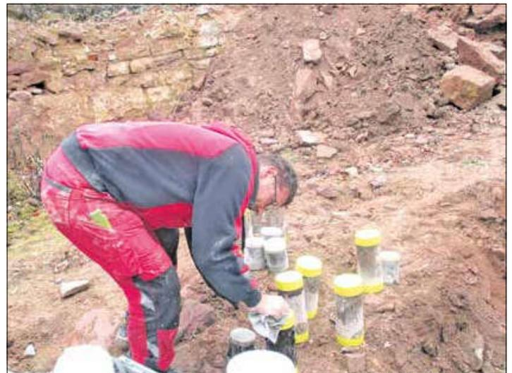
Entnahme der Bodenproben aus verschiedenen Bodenschichten
