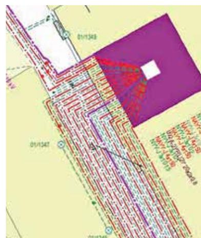
So sieht die Planung der Stromtrassen zu einer Trafostation in der Altstadt aus. Zu sehen sind Unmengen an Steuerungskabeln, Leitungen für die Straßenbeleuchtungen und verschiedene Spannungsebenen bis zu 20.000 Volt (20 kV). Für die Stromversorgung der Häuser wird ein 1-kV-Netz verlegt. Ganz schön spannend ...
