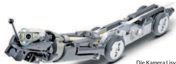
Die Kamera Lisy zur Untersuchung der privaten Grundstücksentwässerungen. Quelle: IBAK
